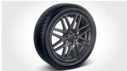
Cerchi in lega BRABUS «Monoblock IX» da 40,6 cm/43,2 cm (16"/17") in grey, torniti con finitura a specchio e dotati di verniciatura opaca
