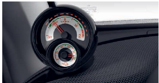
Indicatori supplementari (stato di carica della batteria e indicatore consumi in base alla guida)
